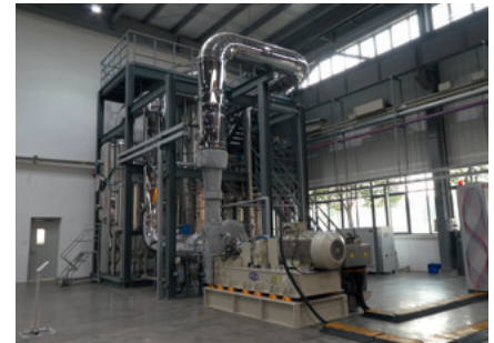
PILLER在中国太仓的降膜蒸发器
