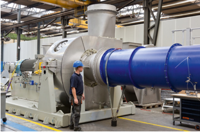
Leistungstest am Rohrprüfstand
