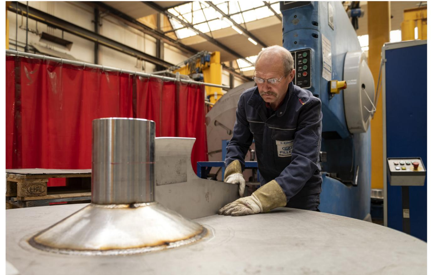
**Fokussiert bei der Sache** Bei jedem Produktionsschritt führen Mitarbeiter immer wieder unterschiedlichste Kontrollen durch – sowohl per Hand mit entsprechenden Schablonen (o.) als auch mithilfe von Maschinen (l.) –, damit alle Einzelteile später auch ihre Aufgaben erfüllen.
